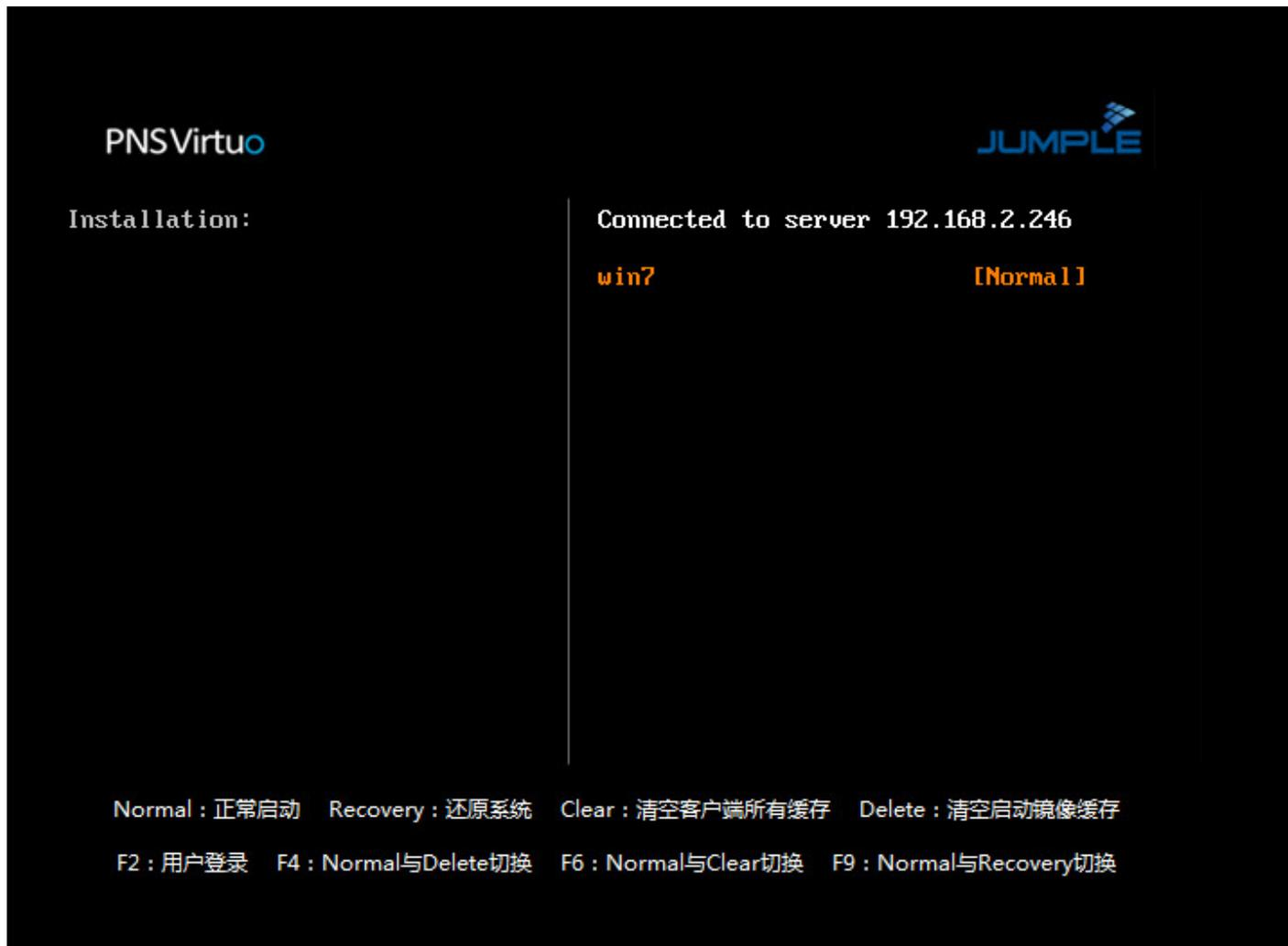
**启动方式选择网络启动**，启动菜单设置里面将用去启动的镜像推送到右边，如下图
