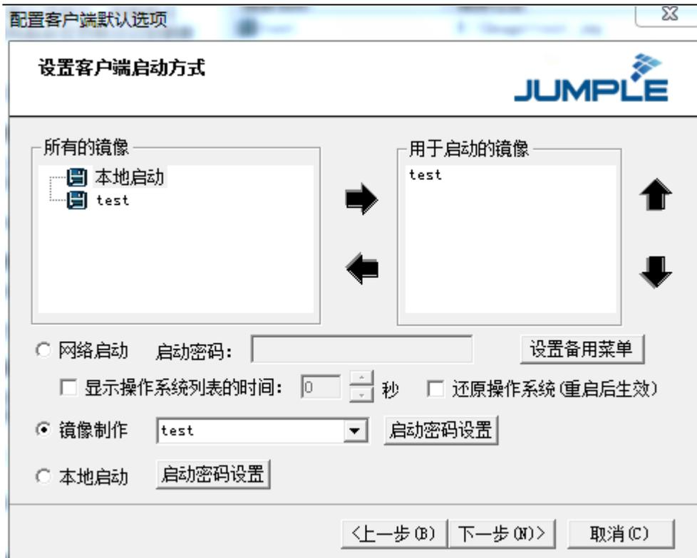
启动方式选择为镜像制作模式，在下拉菜单中找到刚才新建的空白镜像，点击[下一步]
